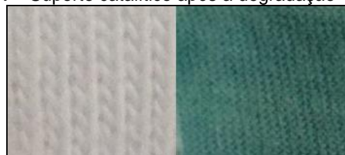
Figura 4 – Suporte catalítico após a degradação
