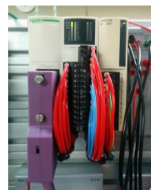
Figura 2. Ilha de comunicação CANOpen com expansão de entradas e saídas analógicas
