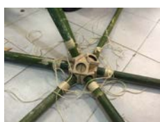
Figura 3 – Hexágono espacial em bambu com conexões amarradas e esferas de isopor, Fonte: autores
