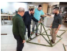
Figura 3 – Hexágono espacial em bambu com conexões amarradas e esferas de isopor, Fonte: autores
