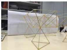
Figura 1 – Modelo de estrutura de cobertura piramidal (esq.), Fonte: autores
