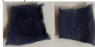
Figura 02 – Fibra após a fixação do corante natural (esquerda) e após a adsorção (direita).
