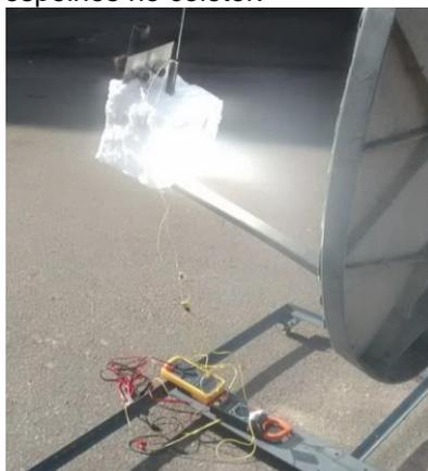
Figura 1 - Coletor solar
