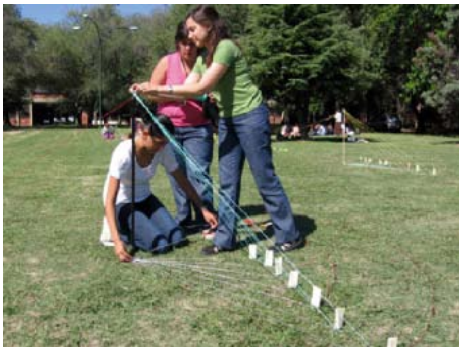
O método das alturas iguais para determinar a linha NS, em Caxias do Sul (página anterior) e em Buenos Aires (acima).
